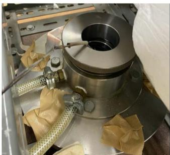
2. 下部プッシュロッドを設置。熱電対を出すための凹部分を上にする。
