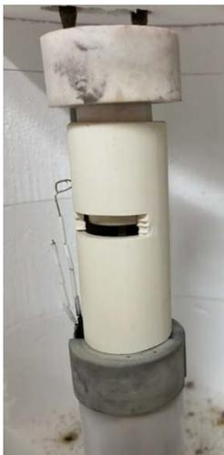
4. 炉心管を設置。下のOリングにうまくはまるように軽く回しながら挿入。強く回し過ぎるとOリングが傷つきます。はまらなかったら1.からやり直し。
